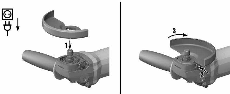
1. Coloque o resguardo de disco na gola do veio de forma que as duas marcas triangulares no resguardo e no produto coincidam.
